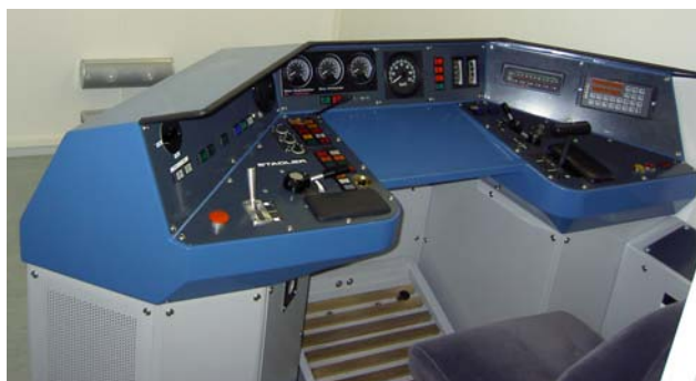
Lo stesso sistema di sicurezza con apparecchiatura originale nel simulatore RAILplus, collegato al computer tramite convertitore e RS232
