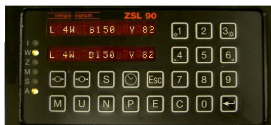
Apparecchio di comando del sistema di sicurezza ZSL90 di AAR e RBS riprodotto al computer (comando tramite mouse o touch-screen)
