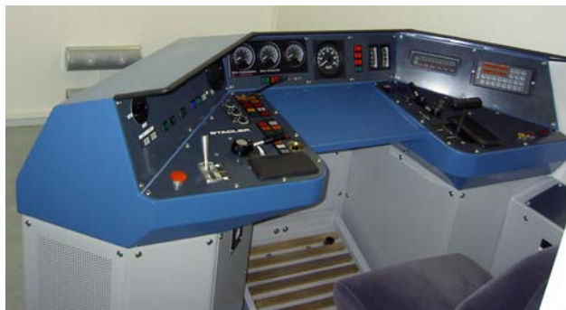
Le même système de sécurité avec appareils originaux sur le simulateur RAILplus, connecté au PC via convertisseur et RS232
