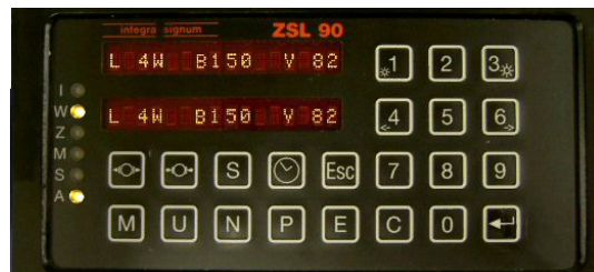
Eingabegerät von RBS- und AAR-ZSL90-Zugsicherung nachgebildet auf PC (Bedienung mit Maus oder Touch-Screen)
