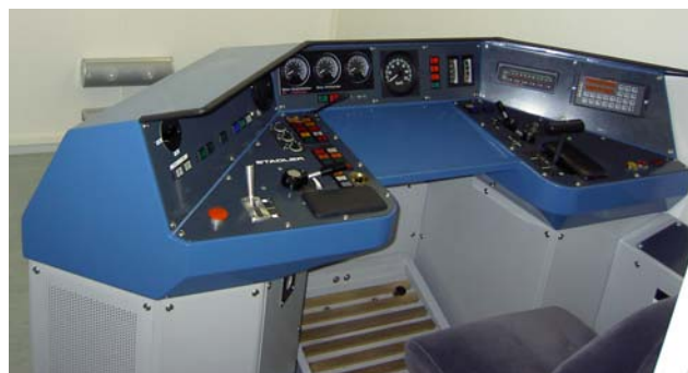
Die gleiche Zugsicherung mit Originalgeräten im Simulator von RAILplus über Umsetzer und RS232 mit PC verbunden
