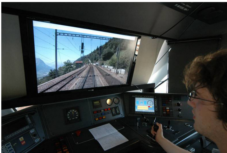
Schermo con supporto nella cabina di guida
