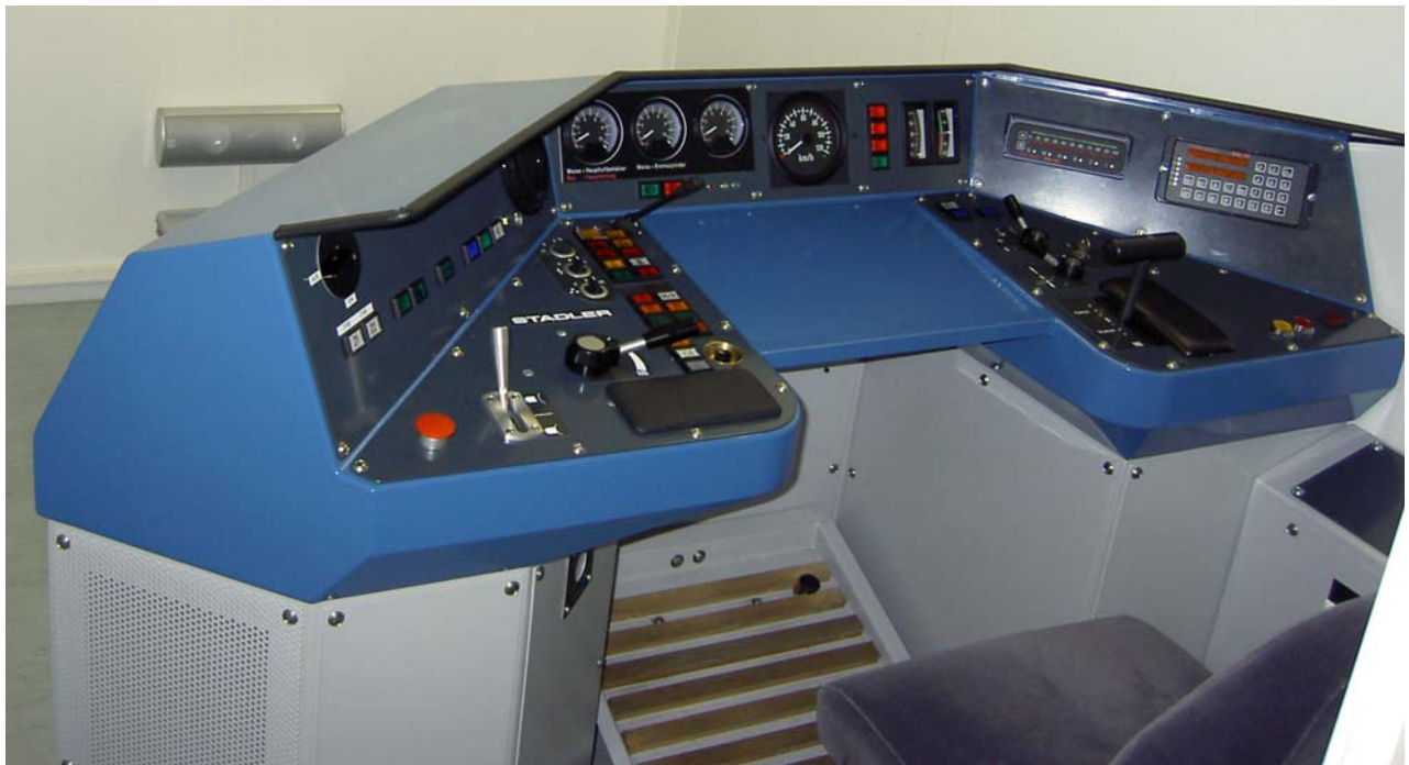
Pupitre de commande Base: rame à plancher bas du chemin de fer Matterhorn-Gotthard
