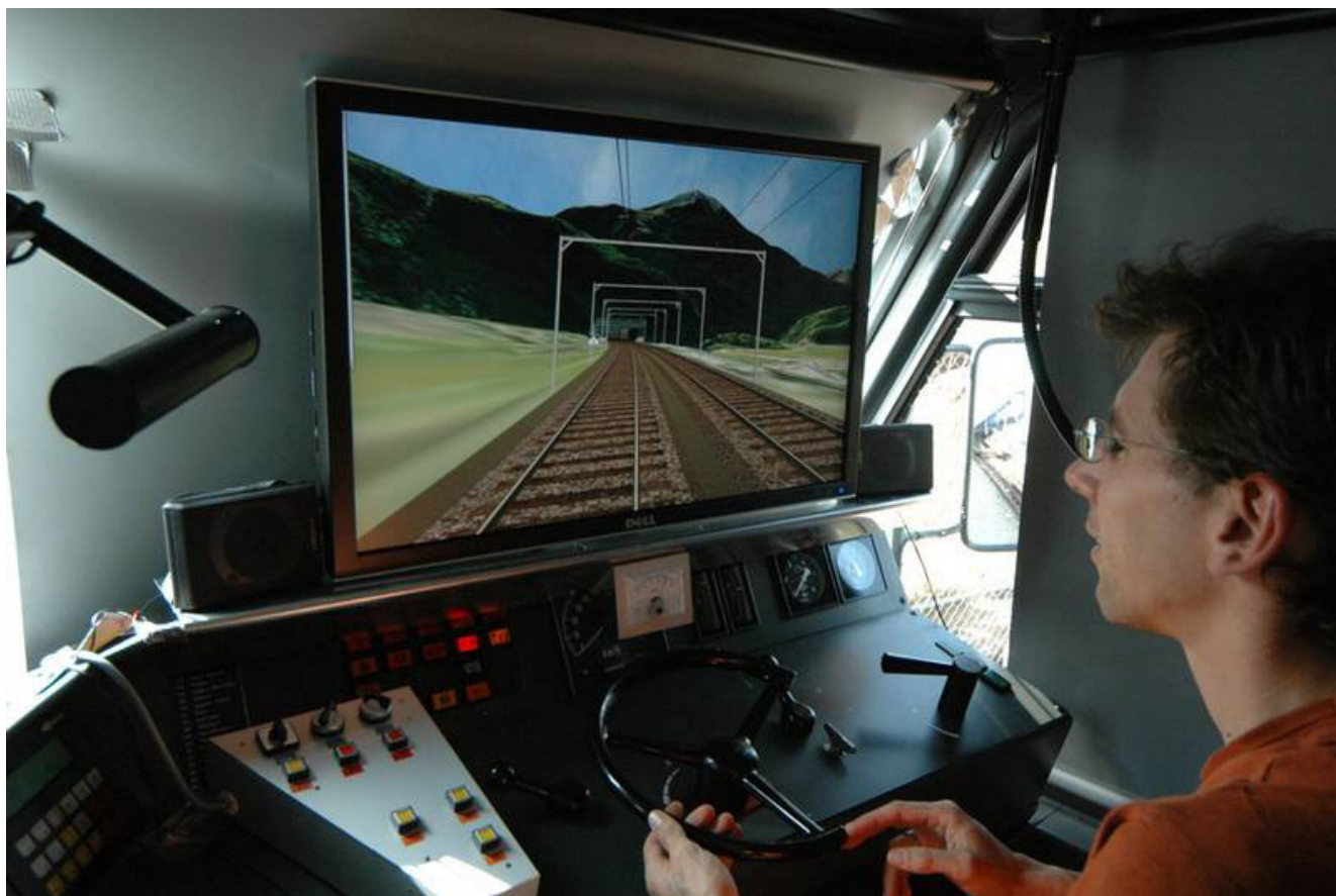
Schermo con supporto nella cabina di guida Elementi sostitutivi per il controllo delle porte nel piccolo box bianco a sinistra
