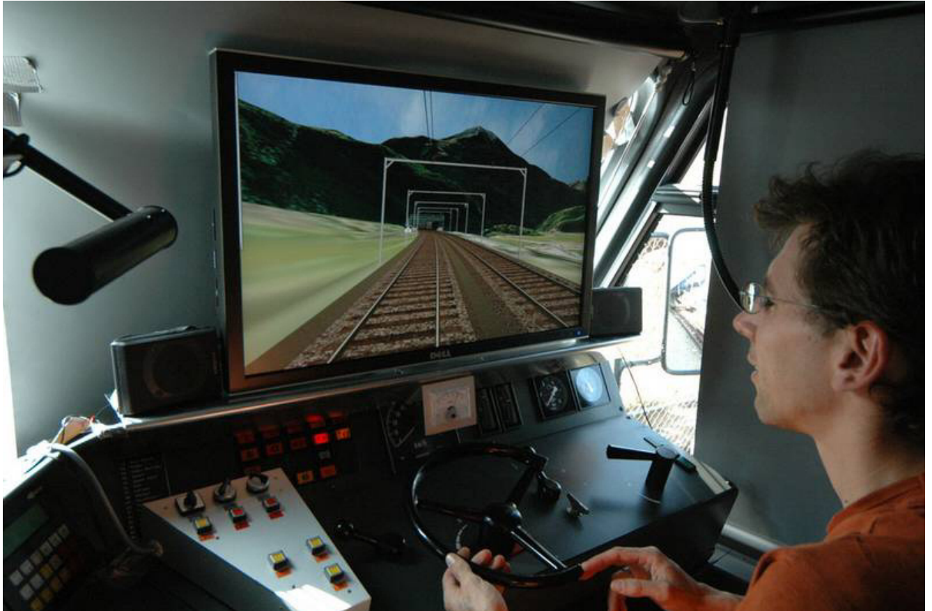
Bildschirm auf Konsole innerhalb Führerstand Zweitelemente für Türbedienung usw. im weissen Kästchen links
